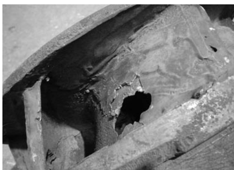
Rys. 3. Uszkodzenie kawitacyjne łopatki wirnika Fig. 3. Cavitation damage on the impeller blade
