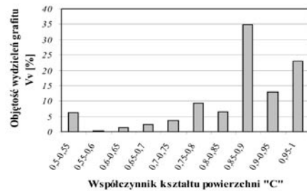
Rys. 4. Objętość wydzielen grafitu „ V_v ” w funkcji współczynnika kształtu „ C ”
