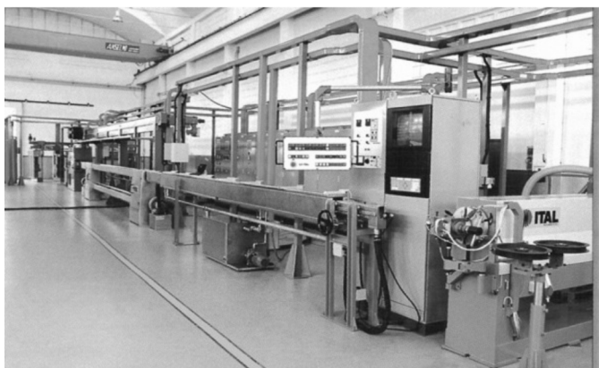
Rys. 6.2. Fragment linii technologicznej wytłaczania powlekającego [9]
