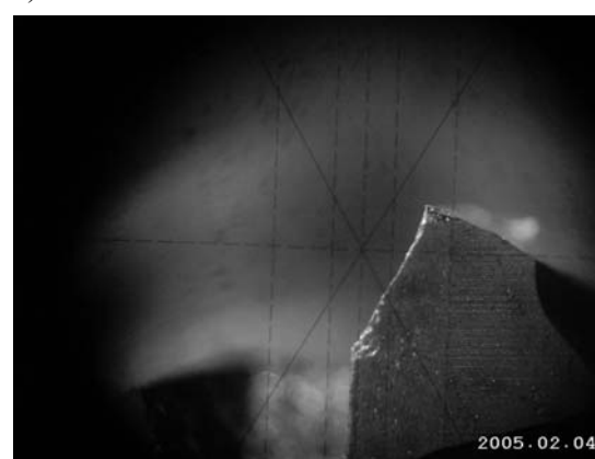
Rys. 8. Wyniki badań zużycia freza palcowego walcowo – czołowego a, b) na powierzchni przyłożenia i narożu, c, d) na powierzchni natarcia i narożu
