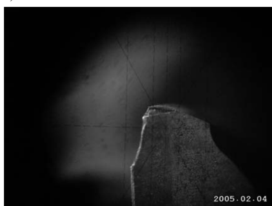
Rys. 8. Wyniki badań zużycia freza palcowego walcowo – czołowego a, b) na powierzchni przyłożenia i narożu, c, d) na powierzchni natarcia i narożu
