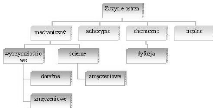
Rys. 2. Klasyfikacja zużycia ostrza Fig. 2. Blade wear classification
