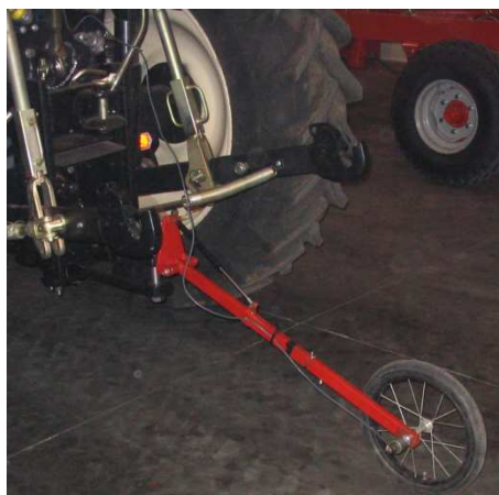
Rys.12. Przykład zastosowania systemu pomiarowego w badaniach skuteczności hamowania
