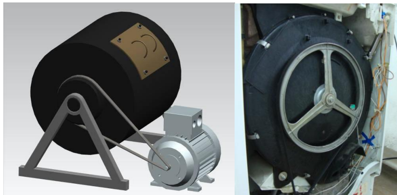
Rys. 1. Koncepcja i realizacja budowy stanowiska laboratoryjnego do badania odporności na ścieranie
