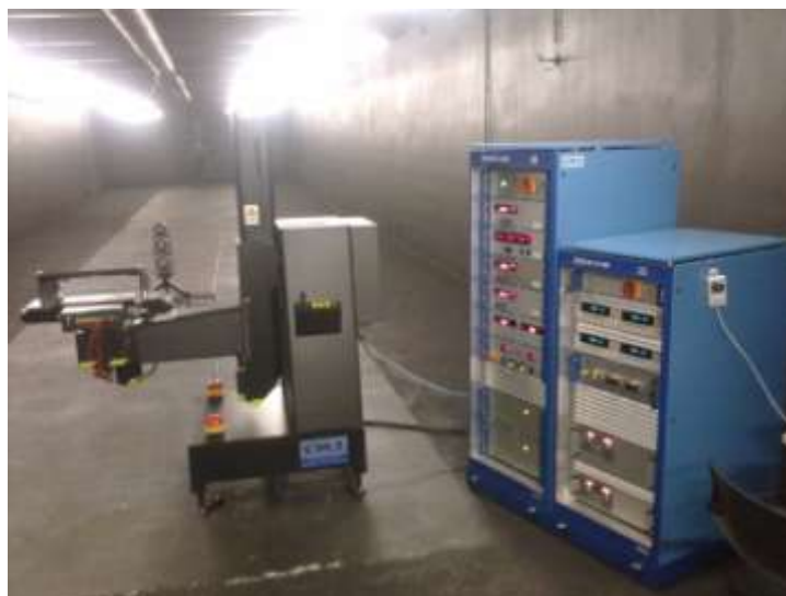
Rys. 4. Tunel pomiarowy do badań fotometrycznych różnego typu lamp samochodowych
