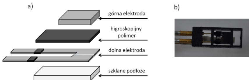
Rys. 3. Czujnik pojemnościowy; a) schemat budowy, b) zdjęcie czujnika [13]
